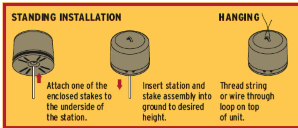
**PLEASE NOTE: THE FILTER SIDE OF THE UNIT MUST BE DIRECTLY FACING THE GROUND ONCE INSTALLED!**
